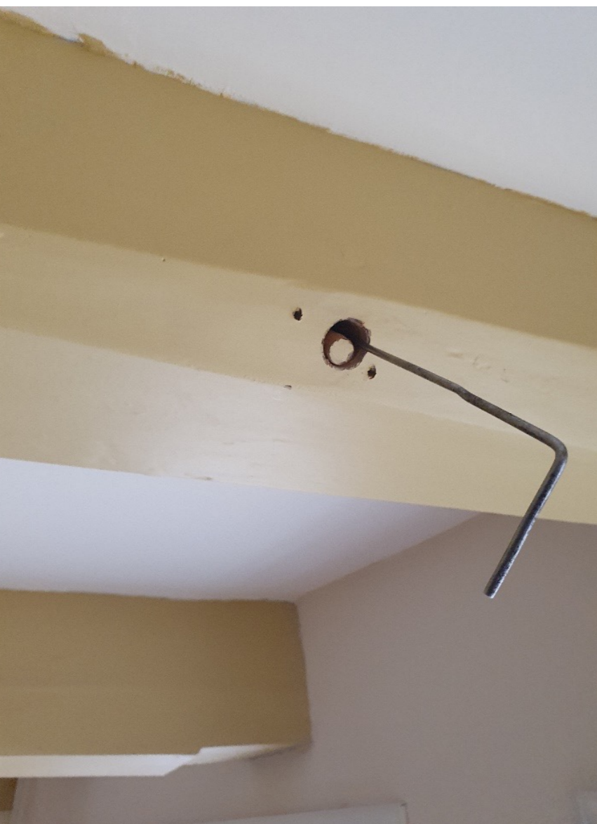
Boring van balk 1. De boorstaal is na de boring blijven staan. Daaruit volgt dat de staal niet gebroken is of dat het oppervlak onder de verf niet helemaal verwormd is.
